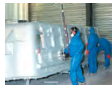
Pose des renforts + résine de protection
