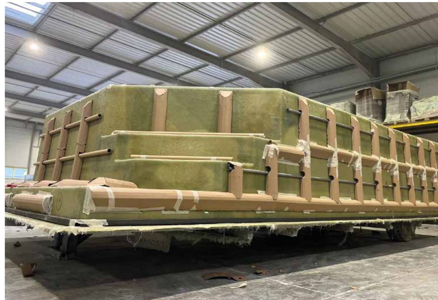
3/ Mise en place des renforts
