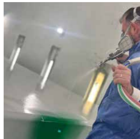
1/ Gelcoatage du moule
