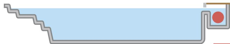
**1** volet immergé dans **SECURE CAISSON**
