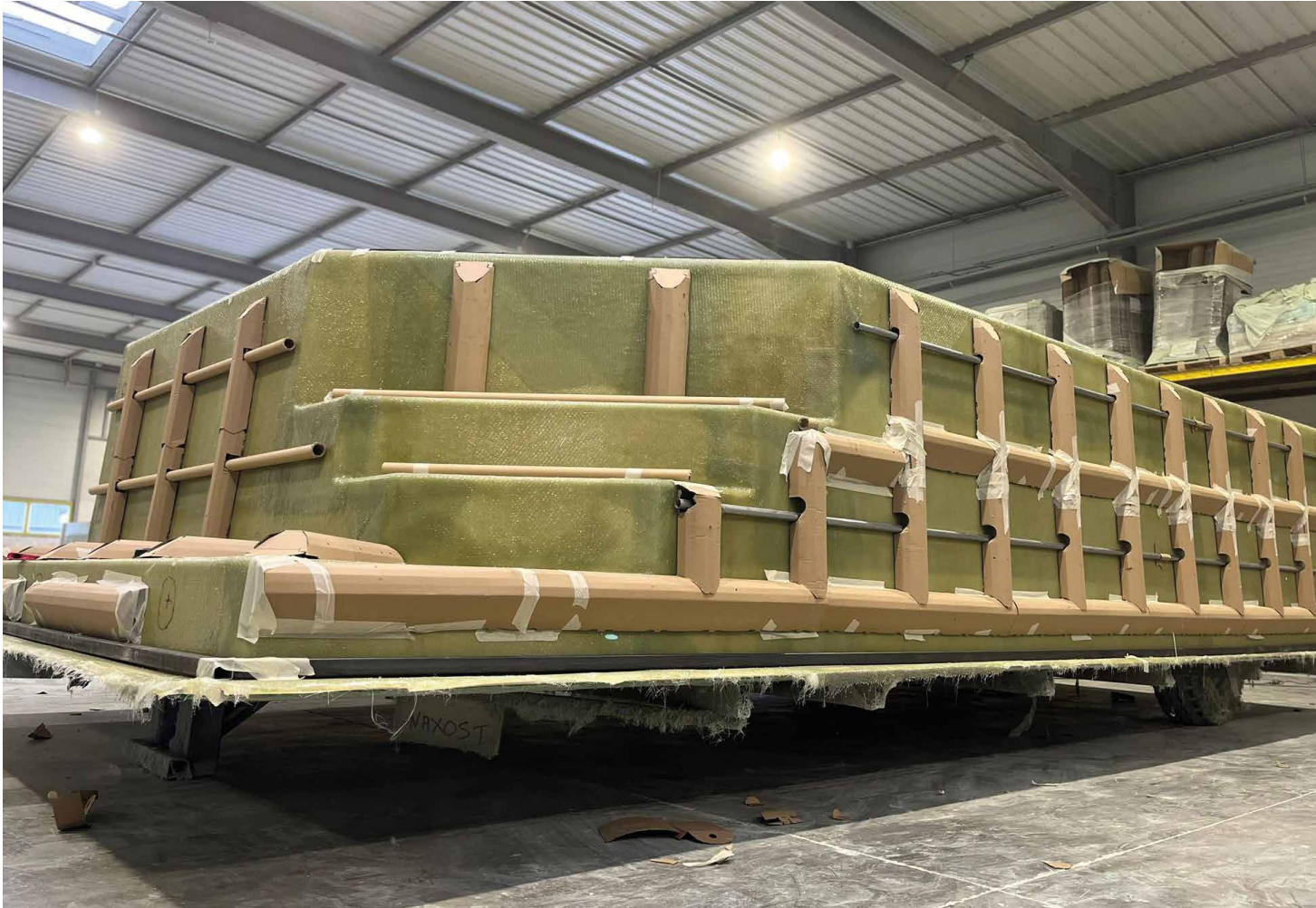
3/ Mise en place des renforts
